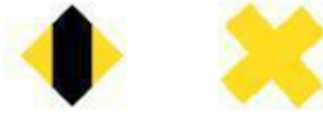
Rysunek 35. Znak usytuowany na lewym brzegu wskazujący przejście z lewego na prawy brzeg.
