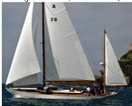
Jol – grotmaszt (wyższy) i bezanmaszt; mały bezan; urządzenie sterowe przed bezanmasztem.
