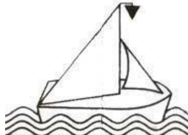
Oznakowanie dzienne: statek napędzany jednocześnie silnikiem i żaglami Znak: czarny stożek skierowany wierzchołkiem w dół
