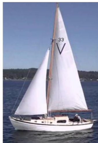
Sluter (jeden maszt, dwa sztaksle, ale postawiony może być tylko jeden)
