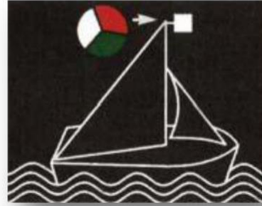
Statek żaglowy Światła: światła burtowe i rufowe położone w jednej latarni na topie masztu
